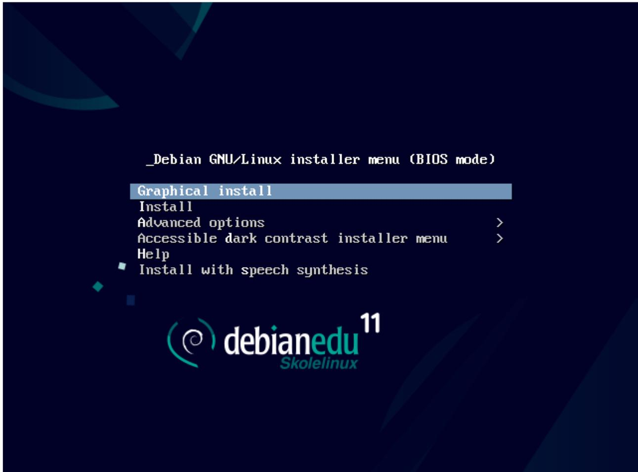
*Instalador gráfico* usa el instalador GTK donde puede usar el ratón.
